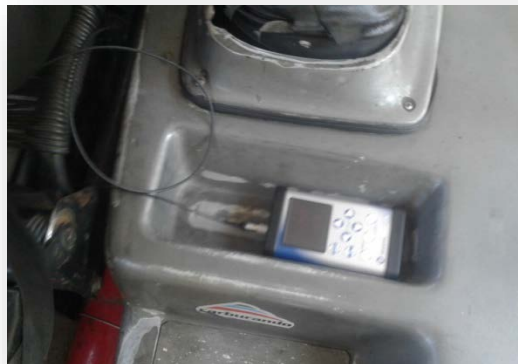
Imagen 7 Equipo para medición de carga térmicas en puesto de conducción de camión. Fuente: archivo de los autores
