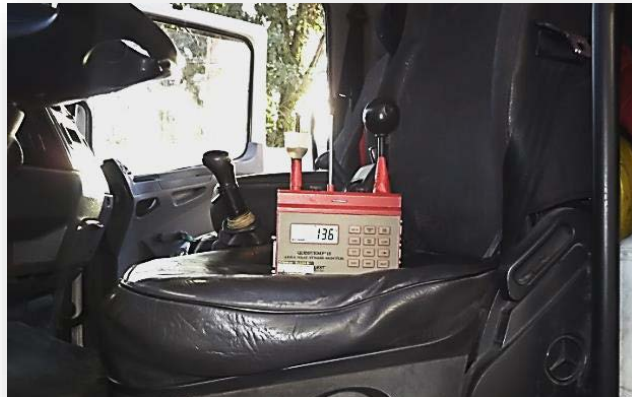
Imagen 6 Equipo para medición de vibraciones de cuerpo entero en puesto de conducción de camión. Sensor ubicado en banqueta de asiento Fuente: archivo de los autores
